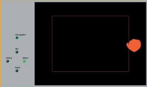
*Sfruttando la relazione metri/pixel il sistema di visione è in grado di mantenere il dirigibile ad una quota stabile; inoltre sempre grazie a m/px il sistema riesce a calcolarsi la distanza tra sé stesso e l'obiettivo.*
